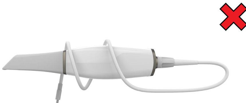
Рис. 17 Неправильное хранение кабеля сканера IS 3800
